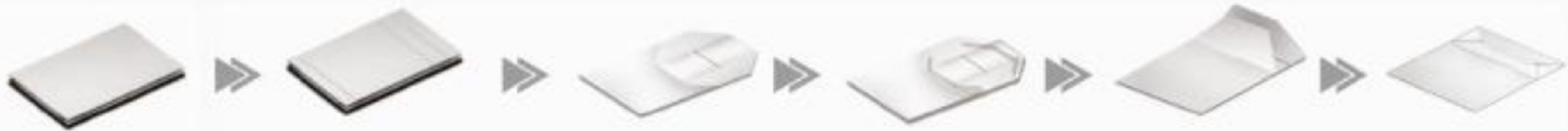
⑧圧着 ⑨底スジ押し ⑩底口あけ ⑪底糊貼り ⑫底貼り ⑬用紙搬出
