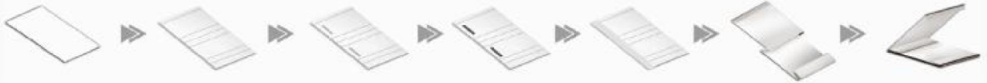
①用紙搬送 ②側面スジ押し ③口ボール入れ ④口ボール貼り ⑤口折り ⑥サイド折り ⑦再度貼り
